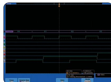
► Affichage du bus parallèle synchronisé, décodage d'un compteur 7 bits.
