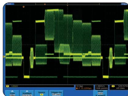
► Affichage d'un signal vidéo NTSC. Notez l'affichage gradué en fonction de l'intensité, émanant de la capacité de la gamme 4000 à représenter la durée, l'amplitude et la répartition de l'amplitude sur la durée.
