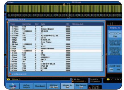
► Table de décodage des paquets montrant un identificateur, un DLC, des données et un contrôle de redondance cyclique décodés pour chaque paquet CAN dans une longue acquisition.
