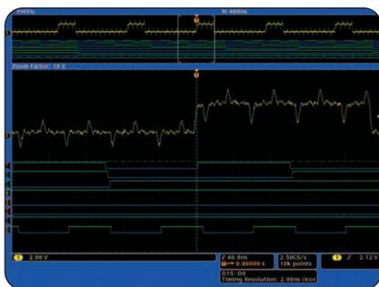
► Les commandes de Wave Inspector offrent une efficacité sans précédent pour l'affichage, la navigation et l'analyse des données de signal.
