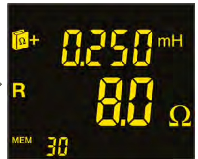
Ecran 3 : valeur de la partie résistive et inductive de l'impédance mesurée
