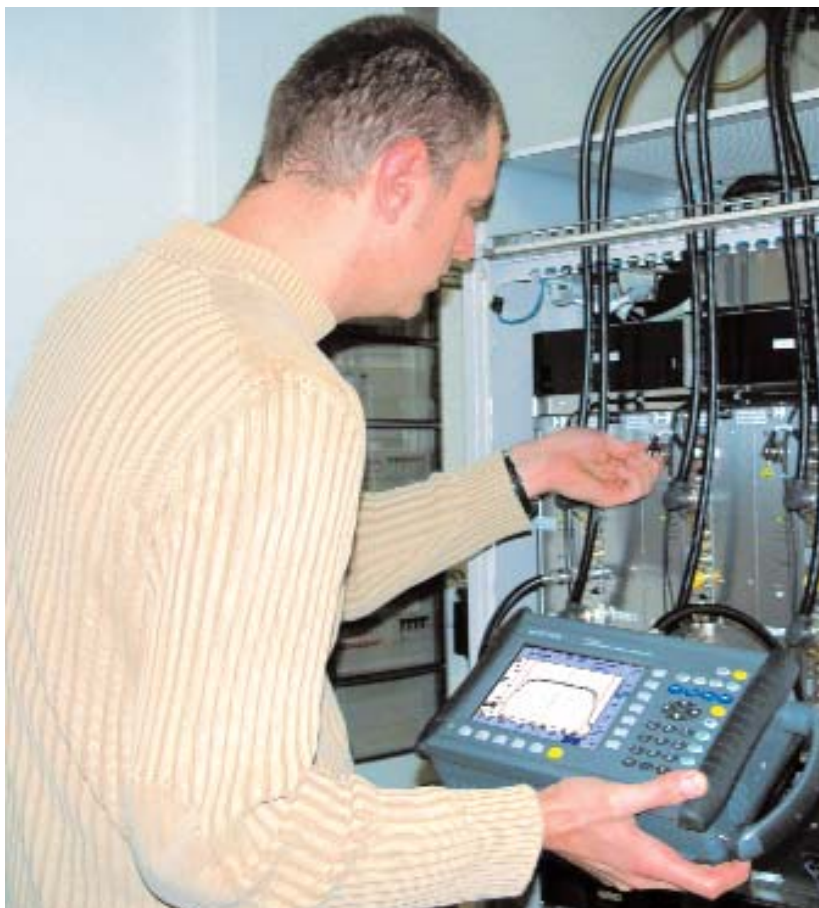
Mesures de puissance des canaux dans une Node B en UMTS
