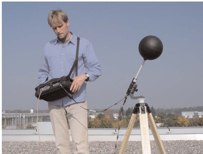
Mesures avec le 9102 Handheld Spectrum Analyzer et la 9171 Isotropic Antenna
